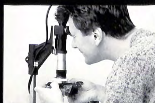
Кулиматор од 200 мм, инструмент за подешавање огледала на фотоапарату
