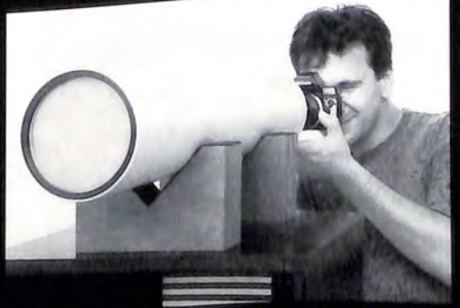
Са Кулиматором од 600 мм се врши контрола бесконачности, контрола фокуса објектива
