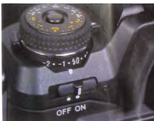
Točkim za kompenzaciju ekspozicije i blica je znatno pojednostavljeno, a ispod njega se nalazi glavni prekidač za isključivanje foto aparata.
