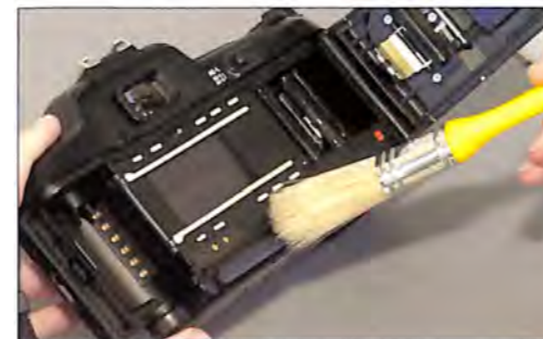
Čišćenje unutrašnjosti foto aparata četkicom
