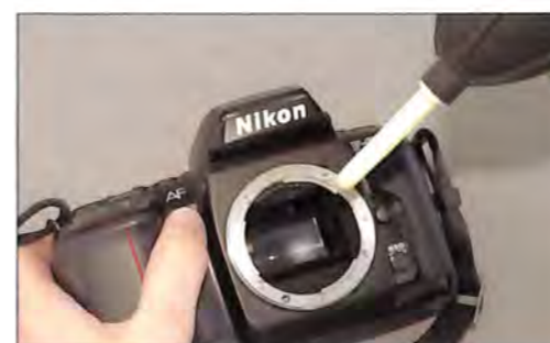
Otklanjanje nečistoća sa refleksnog ogledala pomoću vazdušne pumpice
