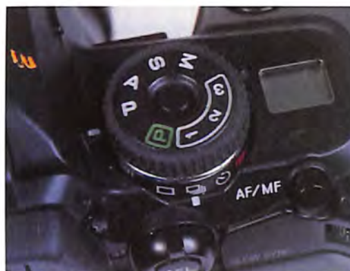
Na tržištu dobro prihvaćenim točkim za izbor režima rada brzo i jednostavno možemo izabrati između potpune automatike (zeleno P), programa, prioriteta otvora blende, prioriteta brzine zatvarača i manualno. Pozicije 1,2,3 možemo sami isprogramirati po želji.
