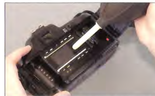
Čišćenje unutrašnjosti foto aparata vazdušnom pumpicom, budite pažljivi da ne dotaknete lamele zavesice
