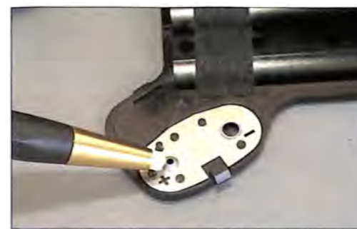
Čišćenje kontakata za baterije pomoću specijalnog čistača u obliku olovke
