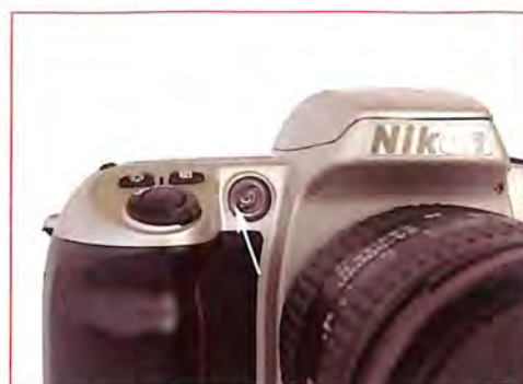
Pomoćno svetlo za izoštravanje koje se nalazi kod nekih foto aparata i kod bliceva može nam pomoći prilikom izoštravanja u lošim svetlosnim uslovima, ali je domet ograničen na kratko odstojanje (na foto aparatima do oko 3m, a na blicevima na oko 10m)
