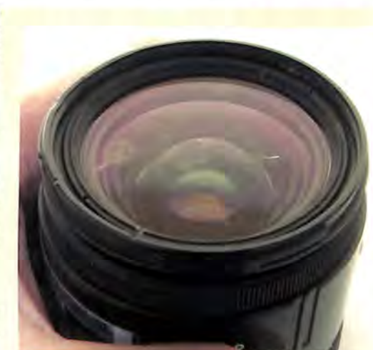
Oštećena površina prednjeg sočiva izaziva neoštrinu
