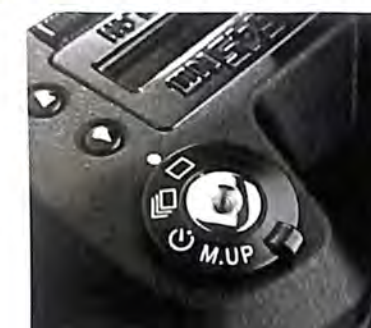
Okidač s prstenom kojim biramo način okidanja
