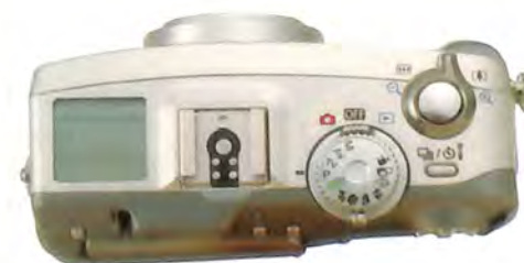
G2 pruža mogućnost korišćenja eksternih Canonovih bliceva iz serije EX
