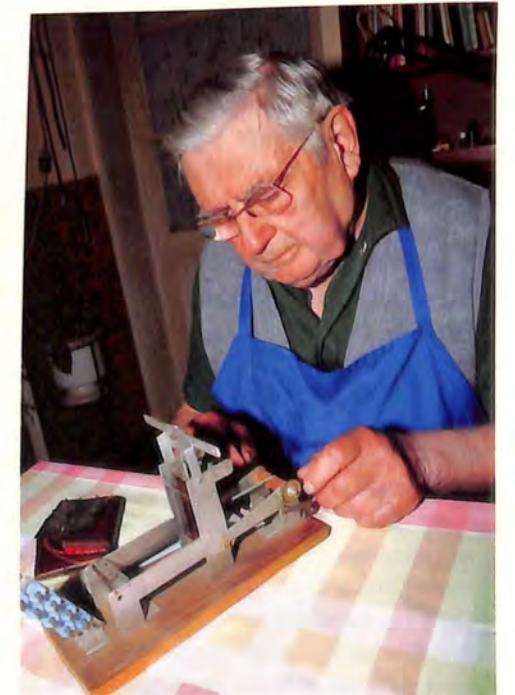
Specijalna mašina za izradu zavesica za razne fotoaparate, koju je takođe napravio subotički mašinbravar
