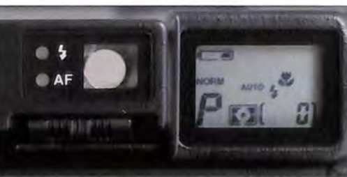
Optičko tražilo s mogućnošću korekcije dioptrije i kontrolni displej na kome možemo videti postavljene elemente za snimanje
