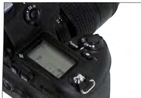
Komandni displej pokazuje sve informacije o postavljenim elementima za snimanje
