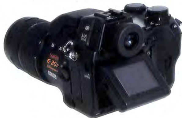
TFT LCD monitor možemo pomeriti 20° nadole i 80° nagore
