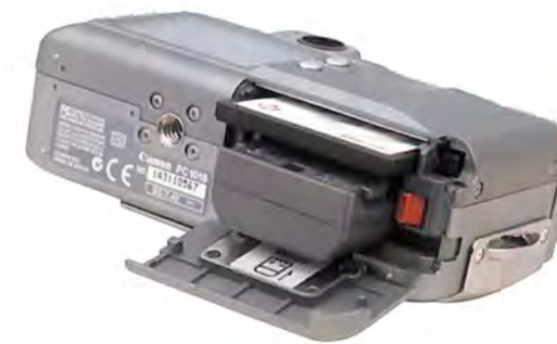
Prostor za punjivu Li-jon bateriju i CompactFlash memorijsku karticu nalazi se iza zajedničkih zaštitnih vrata
