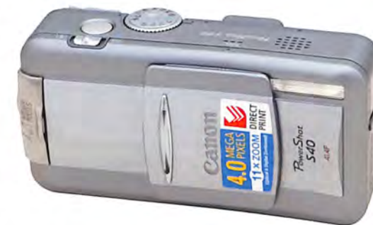
Kada se poklopac kompletno zatvori, efikasno štiti objektiv
