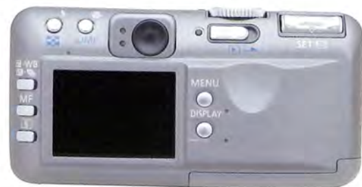
Pored TFT LCD monitora, na zadnjem delu nalazi se većina komandnih dugmadi s jasno označenim funkcijama
