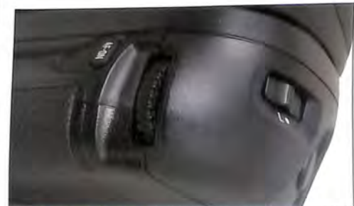
Nosač baterija MB-15 (koji je ujedno i vertikalni rukohvata) pored vertikalnog okidača poseduje dugme za aktiviranje autofokusa i točičić za izbor komandi
