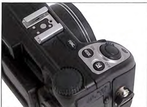
Na gornjem delu nalazi se okidač, s prstenom za uključivanje i točičić za izbor komandi
