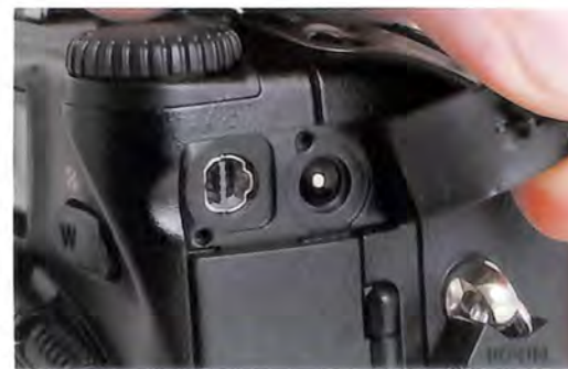
Ispod gumenog štitnika nalazi se USB priključak za vezu s računarnom i priključak za AC adapter
