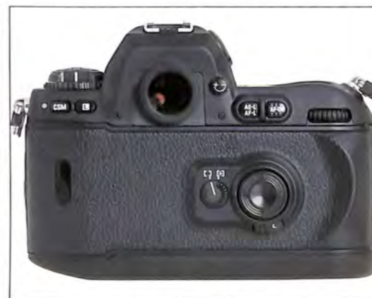
Džojstikom na ledima fotoaparata biramo željeno autofokusno polje
