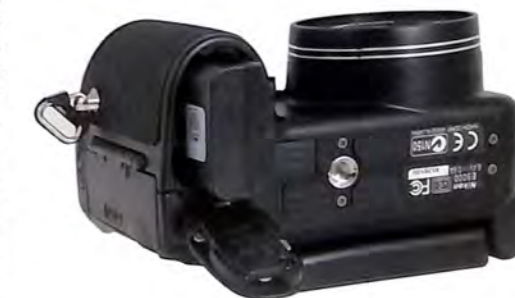
Rukohvat je iskorišćen za smeštaj baterije
