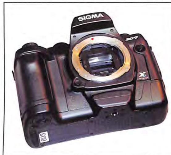
Zaštitni filter štiti senzor od prašine prilikom promene objektivna
