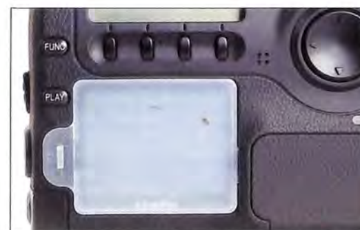
Zaštitni poklopac koji štiti TFT LCD monitor, ali nije dovoljno proziran pa se za bolju kontrolu slike mora skinuti
