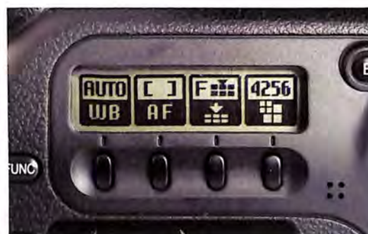
Kontrolni displej sa dugmadima namenjenim za kontrolu rada digitalnog dela fotoaparata
