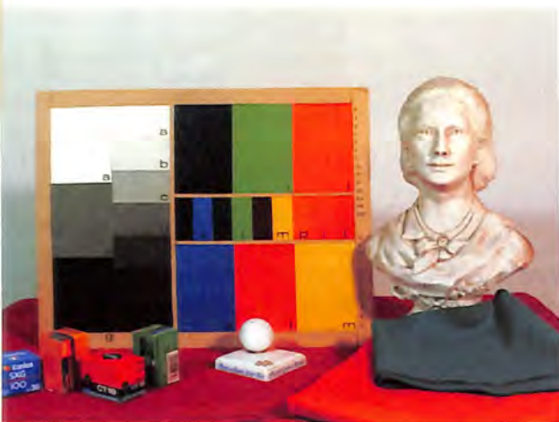
Svetlo desnog izvora je korigovano na 5500K sa konverznim filterom B 12 postavljenim na reflektor - ispravna reprodukcija boja na svim površinama rekvizite. Ekspozicija 1/4 s, blenda 8, desni reflektor pomeren bliže ka objektu kako bi svetlosni odnos i ekspozicija ostale iste.
