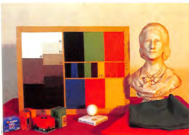
Svetla različitog bojenog karaktera padaju na različite površine istog objekta, film tip D: leva strana je osvetljena sa 5500K i ima ispravnu reprodukciju boja, desna je osvetljena sa 3200K - naglašen crvenkasti štih. Ekspozicija 1/4 s, blenda 8.
