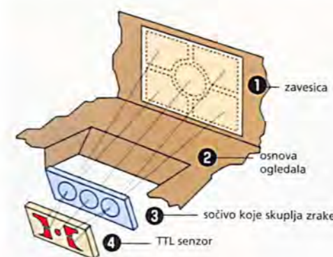
Način funkcionisanja Nikonovog sistema za određivanje blic ekspozicije pomoću predbljeska
