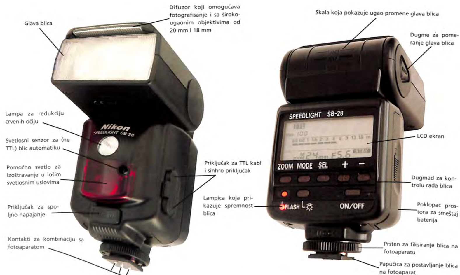
Osnovni konstrukcioni elementi savremenog blica
