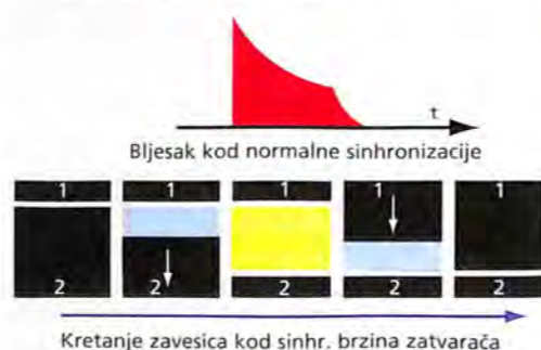
Blic sinhronizacija kod fokalnog tipa zatvarača
