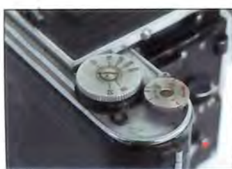
Dva dugmeta za regulaciju ekspozicije na modelu Korelle 6 x 6
