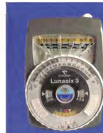
Legendarni ekspozimetar "Lunasix 3" namenjen za merenje reflektovanog i upadnog svetla, raspon ekspozicija od 1/4.000 s do 8 h. U vlasništvu je autora teksta od 1975 g. i još uvek precizno radi uprkos nekoliko ozbiljnih padova o čemu svedoči polomljeno zaštitno staklo na mernoj skali
