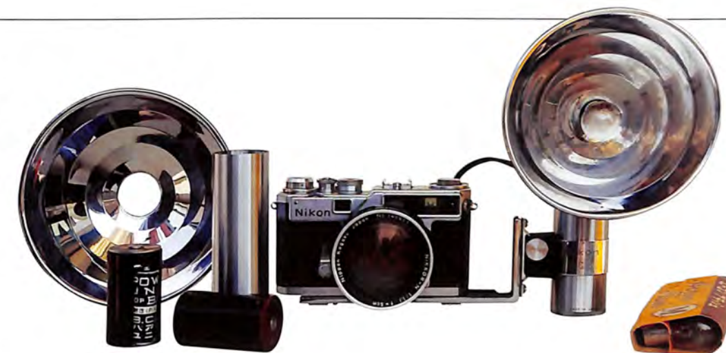
Blic s dodatnim priborom: adapter za tri baterije tipa AA i adapter za baterije tipa D; rezervni reflektor za objektiv od 35 mm; rezervni sijalice i nosač fleša
