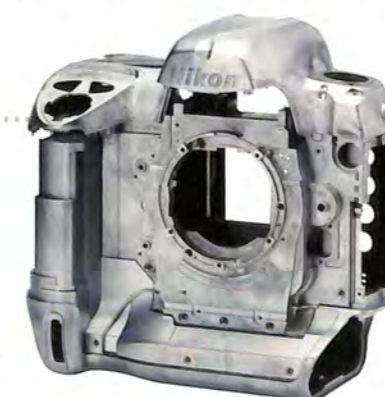
Telo je napravljeno od legure magnezijuma
