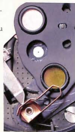
Agfa Clack: detalj zatvarača na kome se vidi ugrađena rupa i nosač s filterima
