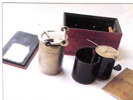
Stari Kodak tank (doza) za razvijanje filma. Komplikovana metalno-drvena konstrukcija omogućavala je da se dobar deo posla obavni na svetlu, ali verovatno ne jakim. Ovakvi tankovi mogu se videti na foto-bazarima i interesantni su u sklopu foto-kolekcije
