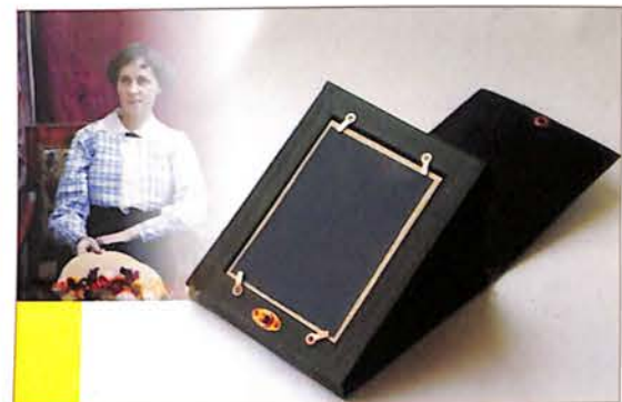
Autohrom ploča jedna je od prvih kolor fotografija pravljen na emulziji u kojoj su suspendovana zrnca skroba u komplementarnim bojama. Ako se poveća, pokazuje strukturu zrna različite boje. Kako se to nije moglo odraziti na papiru, cela konstrukcija s ogledalom omogućavala je da se fotografija posmatra u prolaznom svetlu
