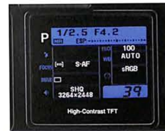
Nema poseban kontrolni displej, ali se sve informacije mogu videti na monitoru
