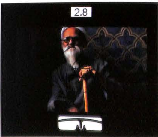
Tražilo fotoaparata Topcon Super DN sa blendom i kazaljkom svetlomera vidljivim u tražilu
