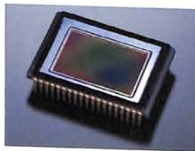
Ovako izgleda senzor digitalnog fotoaparata u formatu APS – to je naš "film" na kome snimamo
