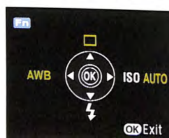
Kada se pritisne dugme "FN" pojavi se mali podmeni za podešavanje osnovnih parametara
