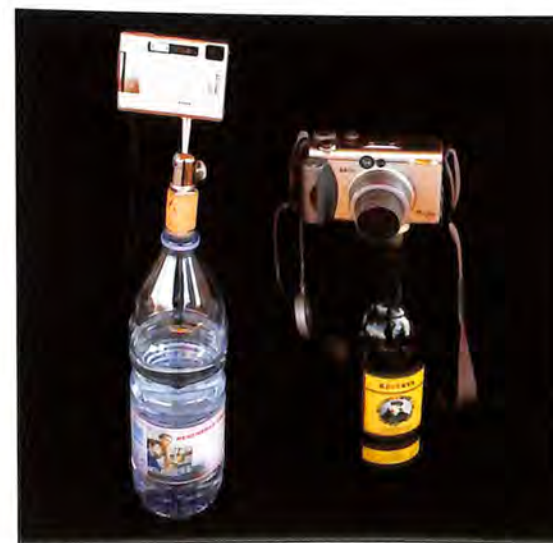
Priručni stativ napravljen od zapušača i zavrtnja 1/4 inča
