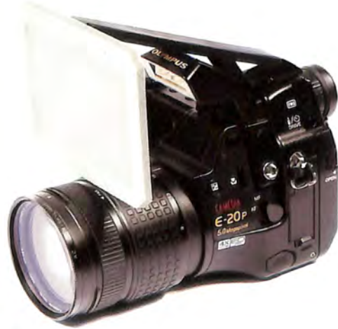
Beli difuzni ekran i nosač iz kućne radionice
