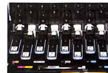
Double Swath tehnologija sa osam kartridža kod štampača HP Indigo press 5500
