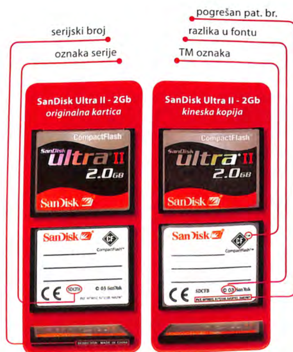
Upoređivanje originalne SanDisk Ultra II memorijske kartice i one koja je kupljena na www.ebay.com a nije originalna
