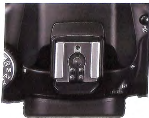
Sina za blic nije ofarbana u crno kao kod ranijih modela, pa neće doći do delimičnog skidanja farbe kada se blic češće stavlja i skida
