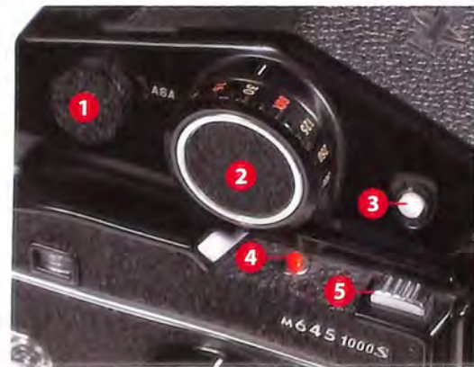
Točič za podešavanje osetljivosti na PD prizmi (1), točak ekspozicija (2), dugme za aktiviranje svetlomera (3), dugme za kontrolu baterija (4), gornji okidač za horizontalne snimke (5)
