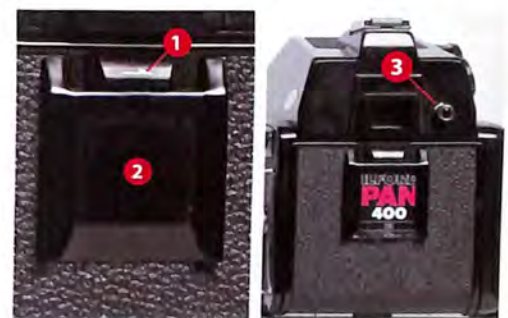
Prostor za smeštaj filma otvara se pomoću poluge (1), ali je moguće samo ako istovremeno pritisnemo i sakrivenu polugu (2) ispod podsetnika, tj. mesta u koje ubacujemo poklopac s kutije filma. Skidanje prizme obavlja se pritiskom i okretom dugmeta (3)
