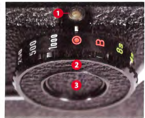
Leva strana kućišta. Kontrolna lampica stanja baterije (1), točič za izbor ekspozicija u položaju za rad s prizmom (2), Promena ekspozicija moguća je samo nakon pritiska na središnji deo (3)
