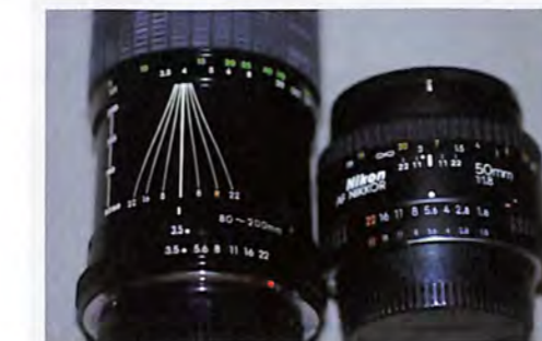
Oznake hiperfokalne oštine na modernim AF objektivima 28 mm i 10,5 mm (obratite pažnju na ekstremno veliku dubinsku oštrinu koja se vidi na skali udaljenosti). Na donjoj ilustraciji vidimo linije koje označavaju područje hiperfokalne daljine na zum objektivu 80-200 mm i klasičnom objektivu 50 mm.
