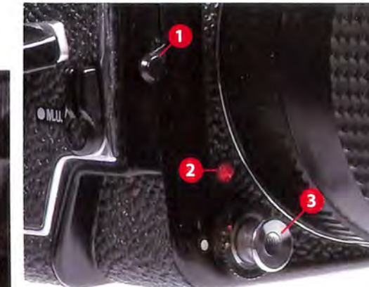
Poluga za kontrolu dubinske oštine (1), crvena oznaka za pravilnu montažu objektivna (2) i donji okidač s kočnicom i navojem za montažu žičanog okidača (3)
