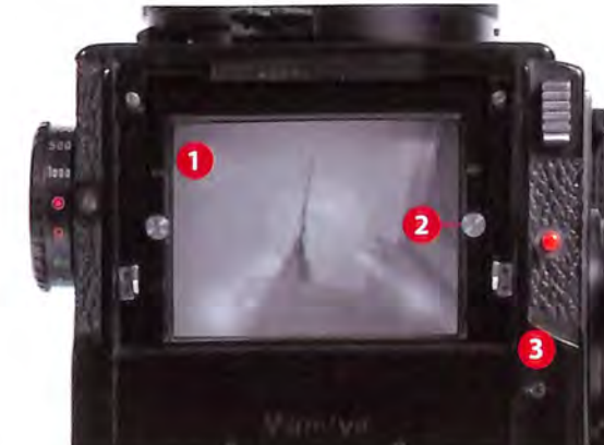
Pogled na mat ploču (1) koja se povlačenjem šrafova (2) lako vadi i menja. Oznaka položaja ravni filma (3) namenjena ručnom (pomoću metra) preciznom izostravanju
