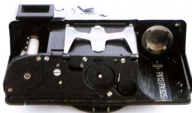
Unutrašnjost fotoaparatusa sa mestom za bateriju u donjem desnom uglu
