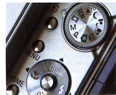
"Komandna tabla" modernog malog digitalca. Na gornjem točkiću vide se piktoگرامи (sličice) koji omogućavaju bezbrižno snimanje u datim situacijama (ako vam nije jasno šta koja slika predstavlja, pročitajte u uputstvu). Ovde vidimo komandu DISP za gašenje displeja da ne bi smetao kada se koristi optičko tražiljo, desno od nje je komanda za blic. Tu postoje opcije A – automatik, A sa slikom oka – automatika s predbleskom radi smanjenja efekta crvenih očiju, slika munje je forsirani blic – okidanje blica i kada ima dovoljno svetla (nju najčešće koristim), i na kraju precrtana munja – isključen blic.
