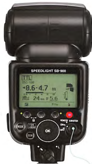
Ovaj prekidač omogućava da blic možete brzo da uključite/isključite, aktivirate daljinsku kontrolu rada blica ili blic postavite kao "master" koji će upravljati drugim blicevima.
