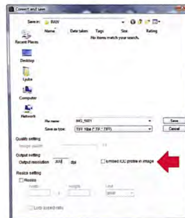
6 Dijalog prozor za snimanje iz DPP konvertora s isključenim kolor-profilom – polje je označeno crvenom strelicom
