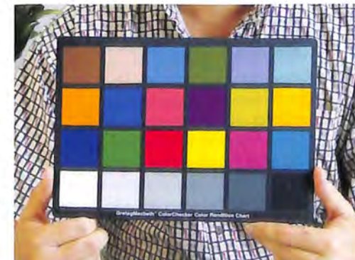
X-rite ColorChecker, predefinisani uzorci boja za kalibraciju
