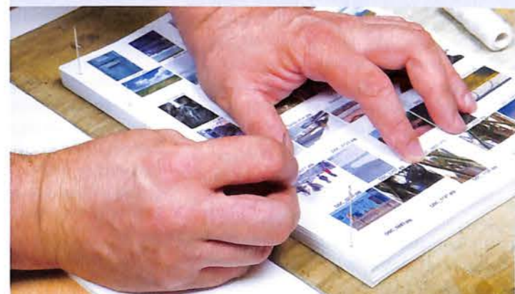
Nakon pažljivog bušenja, gde treba paziti da ne probušimo podlogu, u rupe je dobro ubaciti igle kako bismo sprečili pomeranje stranica, a i bili sigurni da je štos papira probušen do kraja. Igla koju koristimo mora odgovarati prečniku rupe, to jest ušica ne sme biti veća jer ćemo onda morati da je izvlačimo kleštama.
