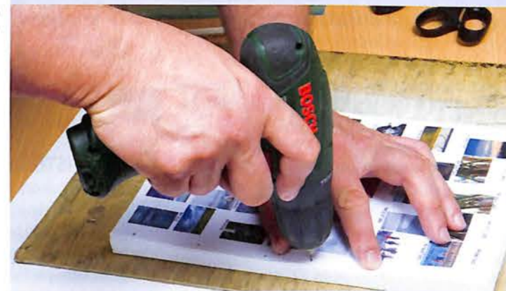
Bušenje je najbolje uraditi burgijom čiji prečnik nije veći od 1 mm jer, u suprotnom, strane se mrdaju, pa moramo koristiti deblji kanap – što nam otežava rad. Tanka burgija zahteva preciznost u radu jer je veoma lako polomiti je. Srećom, nisu skupe, pa je pre početka posla dobro kupiti nekoliko komada.
