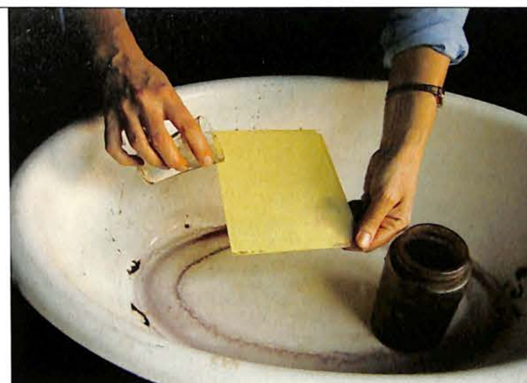
Sipanje razvijачa na ploču
