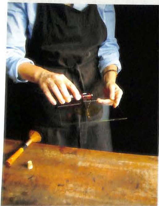
Nanošenje kolodijuma na staklenu ploču
