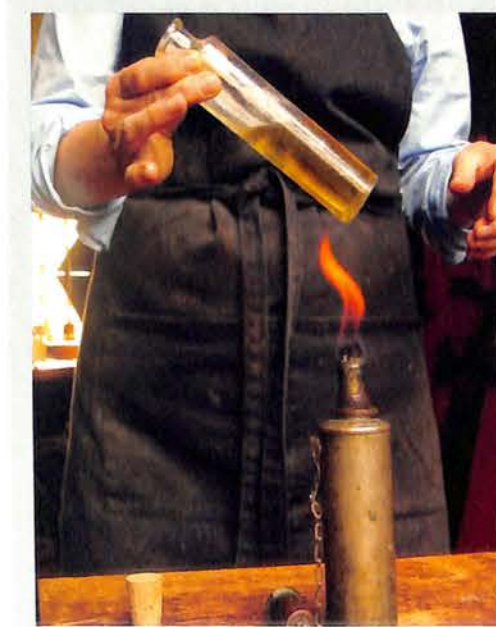
Zagrevanje zaštitnog premaza
