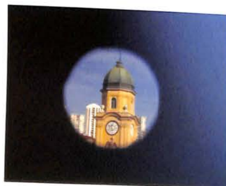
Kada procijenim da je rupica dovoljno oblikovana, stavljam limić-objektiv ispred oka i vidim scenu kako prikazuje sl. 5. Ova rupica je promjera cca 0,3 mm.
