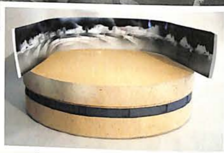
LJUBIĆ je kamera obskura koja snima puni krug 360 stepeni. Nekoliko sam ih konstruirao za lajka film, roll film, te fotopapir gdje je veličina negativa 10 x 100 cm. Fotografija gore snimljena je kamerom obskurem LJUBIĆ 15, na fotopapiru osvijetljavano 110 sekundi. Fotografija: Borislav Božić
