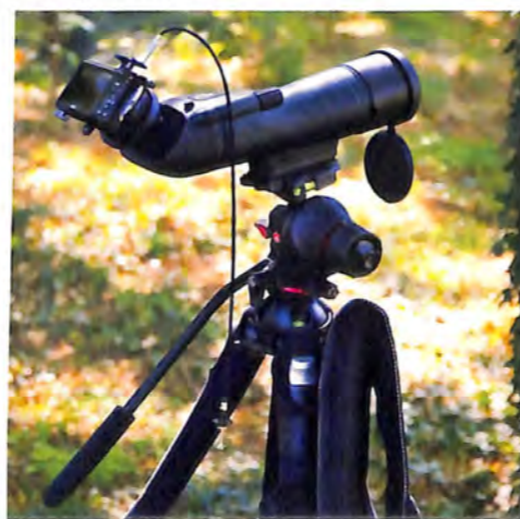
Teleskop montiran na stativ pomoću Manfrotto 055 Hybrid Head Q5 koja obezbeđuje "mekano" kretanje
