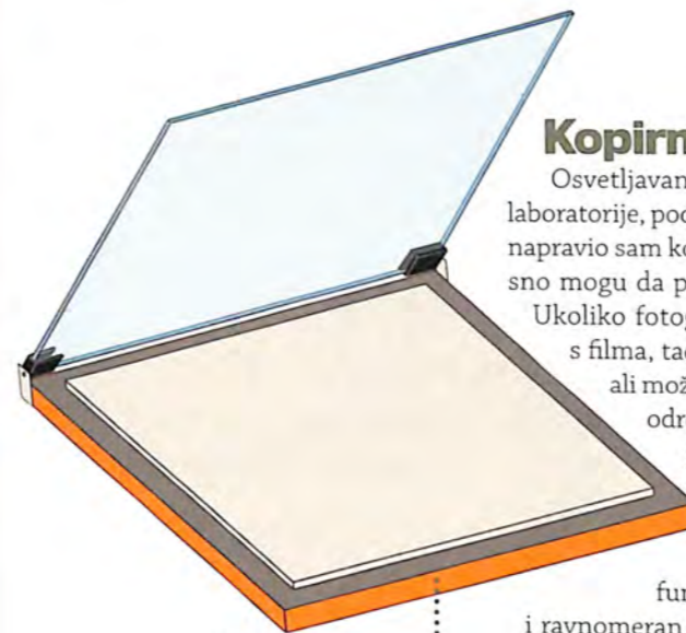
Skica kopirnog rama, napravljenog od parčeta stakla debljine 5 mm, dva nosača staklenih vrata za vitrinu, dva metalna ugaonika i panel ploče. Veličinu prilagodite svojim potrebama.
