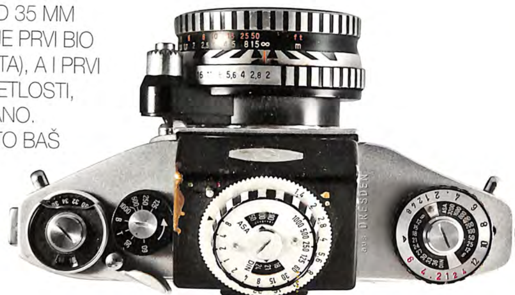
Elbaflex snimljena odozgo tako da se vidi poluga za premotavanje i okidač na levoj strani.
