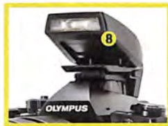
8. BLIC: Za razliku od ostalih CSC fotoaparata napravljenih u D-SLR stilu nema ugrađeni blic, već samo šinu s kontaktima. Uz njega se dobija mali eksterni blic FL-LM2 koji može poslužiti i kao komander za daljinsko upravljanje eksternim blicevima bez dodatnih kablova. Mogućnosti upravljanja uključuju nezavisno regulisanje blica i postavki korekcije snage blica za do tri grupe bliceva i četiri kanala.
