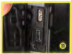
11. PRIKLJUČCI: Iza većeg fleksibilnog gumenog poklopca krije se kombinovani USB/video konektor preko koga se fotoaparat može povezati sa žičanim daljinskim okidačem RM-UC1 i HDMI priključak za reprodukciju fotografija i video zapisa na televizorima. Drugi poklopac krije priključak za eksterni mikrofoni.
