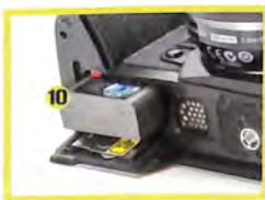
10. BATERIJA: Koristi istu BLN-1 bateriju kao i u fotoaparatu E-M5 i E-P5, koja prema CIPA standardu može da snimi oko 350 snimaka. Ako se koristi Wi-Fi, broj snimaka može biti prepolovljen, tako da je malo čudno što "Olympus" nije iskoristio dodatni prostor u rukohvatu i napravio veću bateriju koja bi imala i veći kapacitet.
