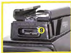
9. PRIKLJUČAK ZA PRIBOR: E-M1 ima AP2 priključak za pribor koji omogućava korišćenje niza dodataka napravljenih za PEN i OM-D seriju fotoaparata kao što su: makroosvetlivač MAL-1, bluetooth modul PENPAL PP-1, ali i mali blic FL-LM2 koji se dobija s fotoaparatom.
