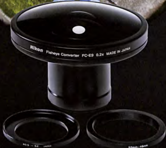
Nikon FC-E9 Fisheye konverter u osnovi dva puta skraćuje žižnu daljinu objektiv na koje je montiran. To znači da objektiv od 28 mm daje sliku koja odgovara objektivu žižne daljine od 14 mm uz odgovarajuće iskrivljenje karakteristično za fisheye objektiv.
