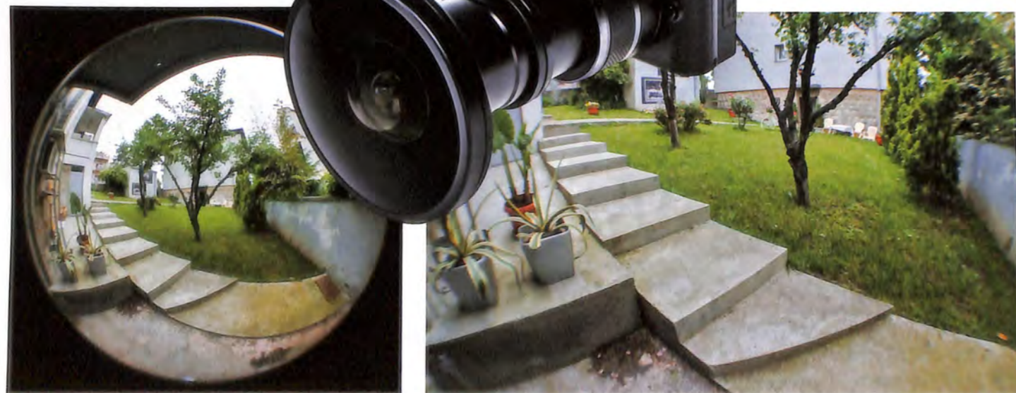
Nikon FC-E9 Fisheye konverter u osnovi dva puta skraćuje žižnu daljinu objektiv na koje je montiran. To znači da objektiv od 28 mm daje sliku koja odgovara objektivu žižne daljine od 14 mm uz odgovarajuće iskrivljenje karakteristično za fisheye objektiv.
