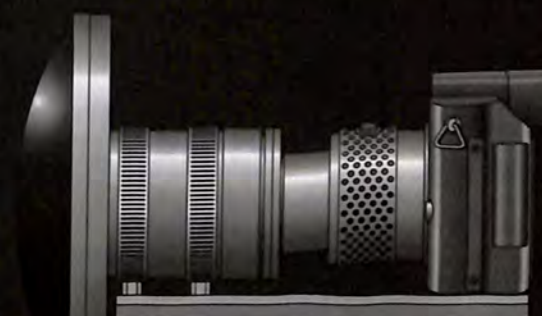
Skica nosača koji će omogućiti bezbedan rad s teškim konverterom. Uz malo dodatnog truda moguće je napraviti nosač po kome će fotoaparatom moći da se pomera napred-nazad, što će obezbediti i zumiranje, funkciju koja nije dostupna ako je udaljenost od konvertera fiksna.
