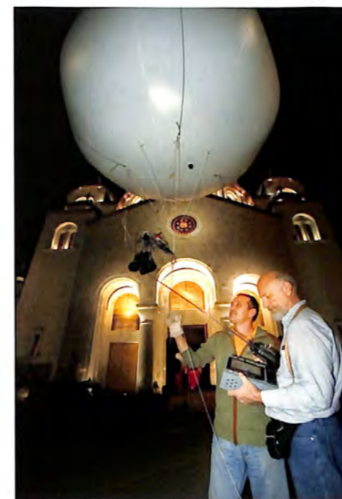
Helijumski balon sa sistemom daljinske kontrole pozicije i ostalih parametara fotoaparata Aleksandar Milojević i Dragoljub Zamurović proveravaju kompletan sistem pre fotografisanja. Snimio: Marko Zamurović
